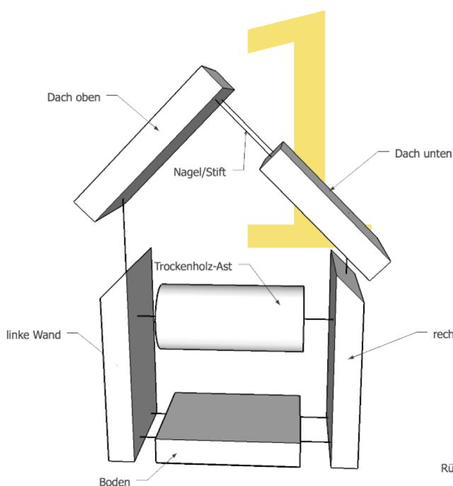
Löcher für Nägel bohren ( $\varnothing$  1,5 mm)
